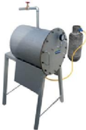
Figura 2. Prototipo de reactor de pirólisis
