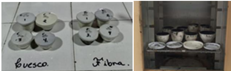
Figura 14., Crisoles con tapa y mufla para la calcinación de los carbones
