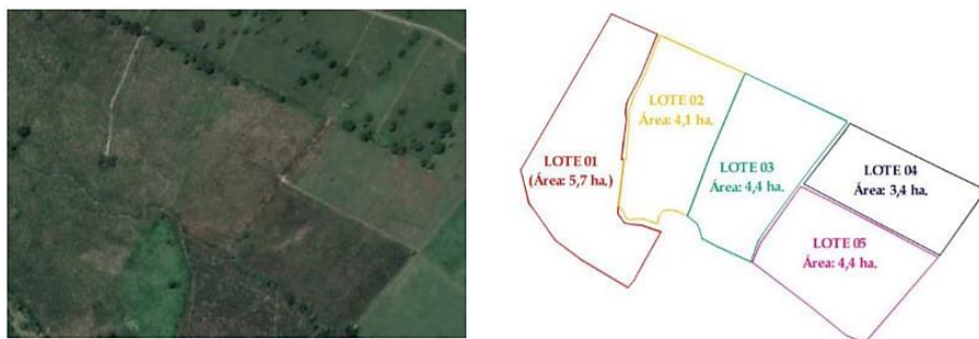
Figura 1. Imagen aérea de la parcela con sus cinco (5) lotes y levantamiento topográfico.
