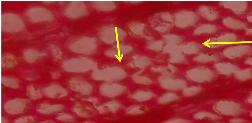
Figura 2. Degradación de la pared celular y lámina media Causada por *T. versicolor* sobre la madera de aliso
