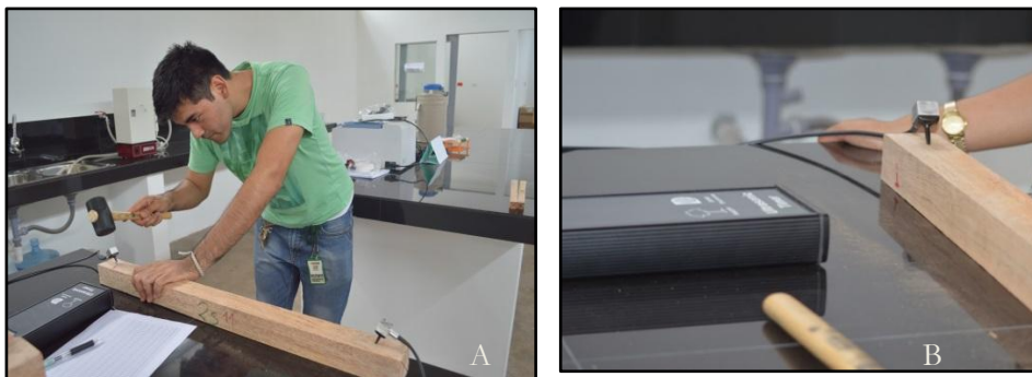
Fig. 2. Evaluación con ULTRASONIC TIMER. A. ubicación de sensores. B. Toma de datos de tiempo
