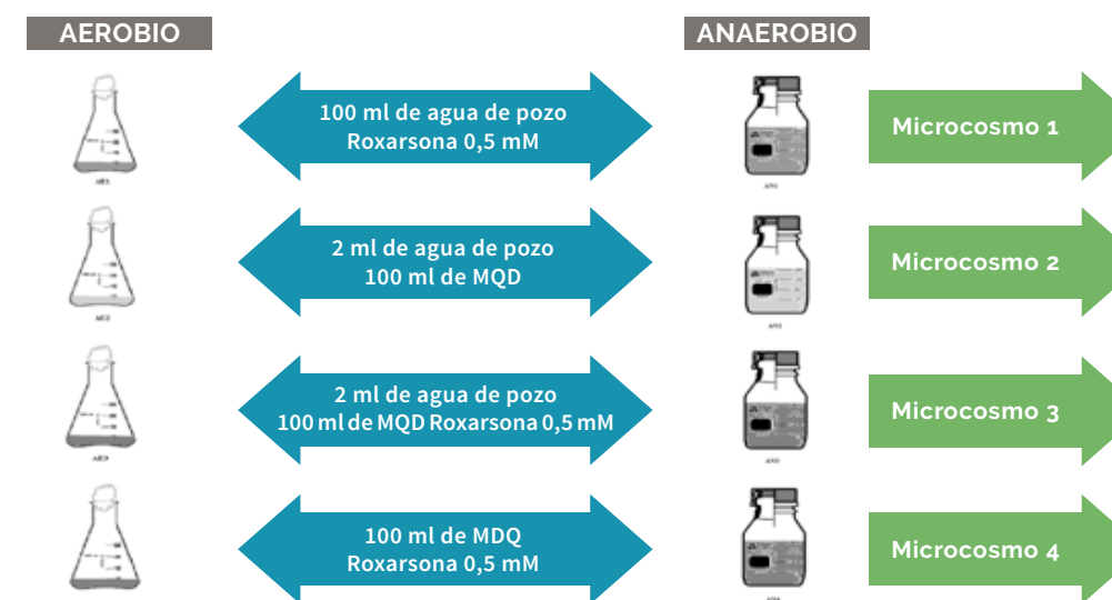
FIGURA 1 Preparación de muestras a) condiciones aerobias, b) condiciones anaerobias
