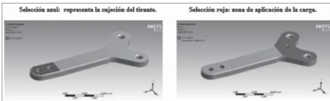
Figura 15. Restricciones y carga en el tirante (Autores, 2017)
