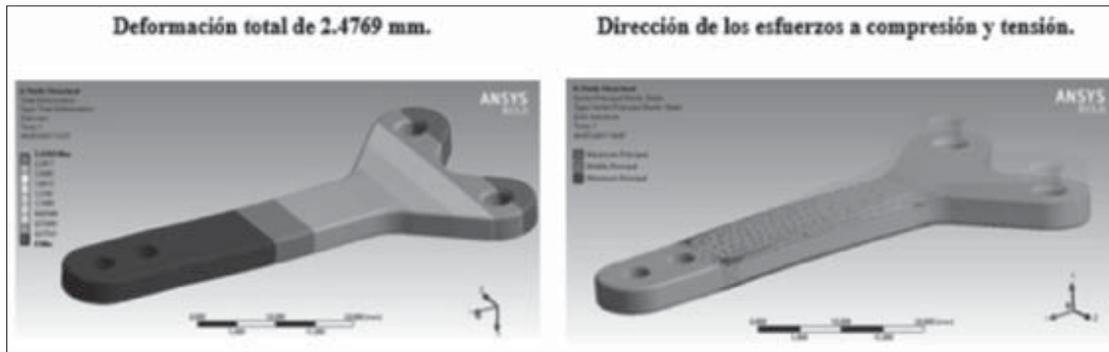
Figura 16. Resultados de deformación y dirección de los esfuerzos
