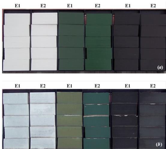
Figura 1. Probetas de madera de *A. quebracho blanco* estabilizada con PEG, pintadas con esmaltes sintéticos E1 y E2 en diferentes colores, (a) al inicio del período de exposición y (b) a los 360 días de exposición a la intemperie.
