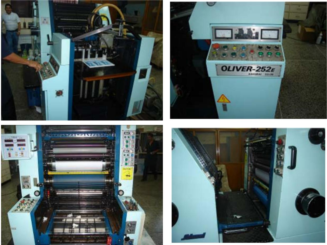
**Fig. 5.9 Prensa para impresiones Offset Sakurai.**
