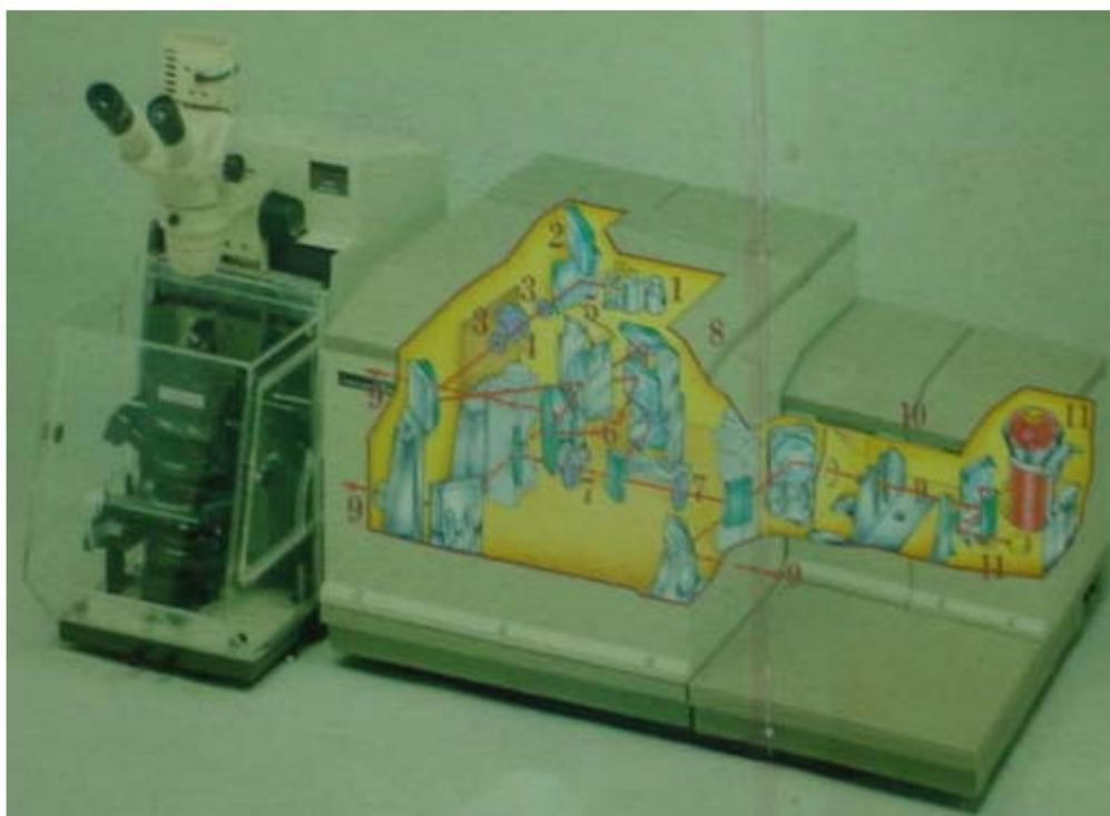
**Fig. 5.28 Diagrama del Infrarrojo Perkin Elmer.**
