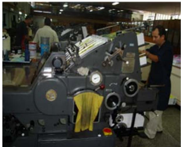
**Fig. 5.10 Prensa para impresiones Heidelberg de ½ pliego.**
