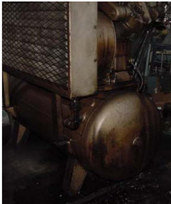
**Fig. 5.42 Compresores en el Laboratorio de Operaciones Unitarias (cont.).**
