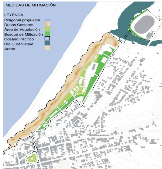
Figura 3. Medidas de mitigación de riesgo de tsunami
