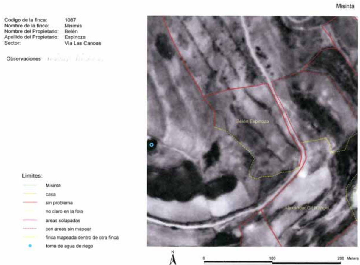
Figura 8: Ejemplo de uno de los mapas utilizados como base para la verificación de linderos y la sectorización de la finca.
