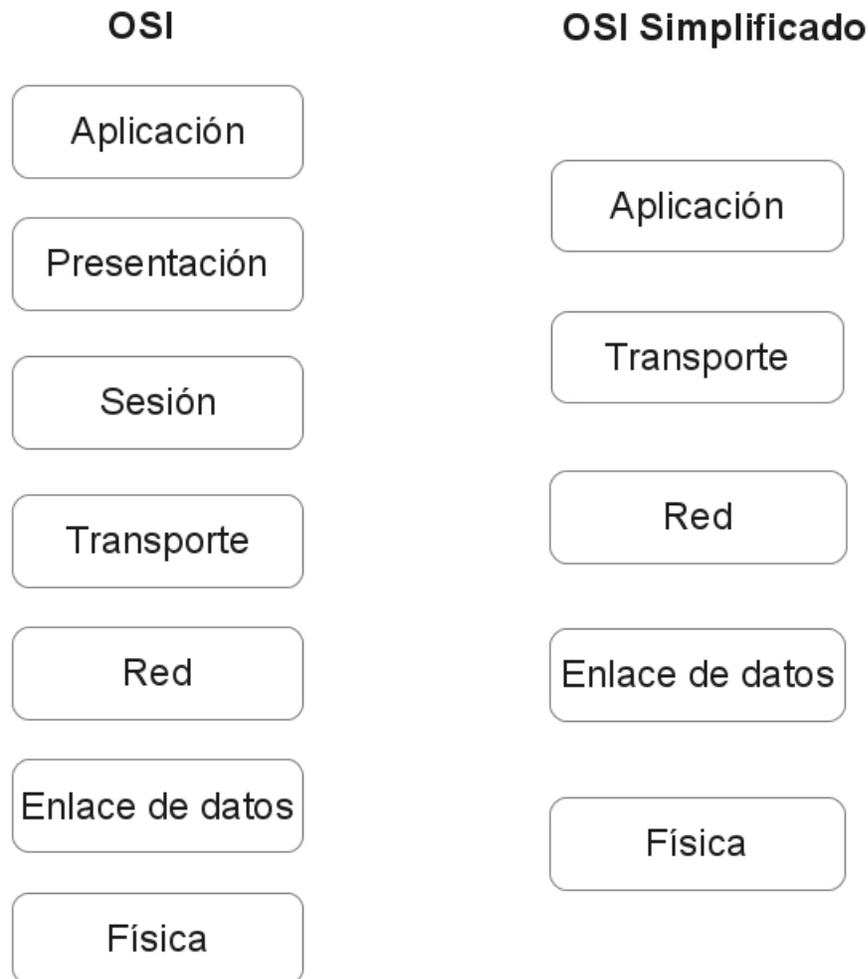
Figura 2.1: Capas de Modelo OSI y OSI Simplificado
