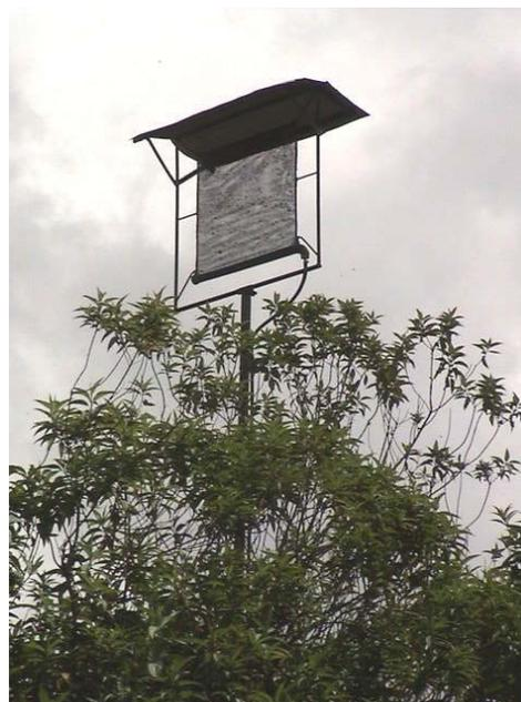
**Figura 2.** Neblinómetro SFC utilizado para la intercepción de neblina. Foto: H. Fonseca.
