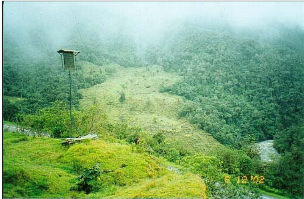
Fotografía 9. Neblinómetro de pantalla utilizado para estimar la interceptación de neblina.
