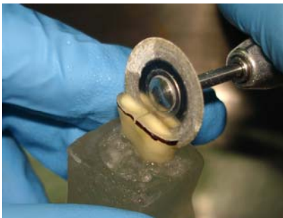
Fig. 3. Corte longitudinal del diente para obtener los especímenes de dentina.
