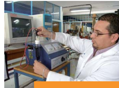
Con el Deshidratador Electrostático de Laboratorio se pueden probar rápidamente las formulaciones deshidratantes del crudo (Fotografía Ramón Pico)
