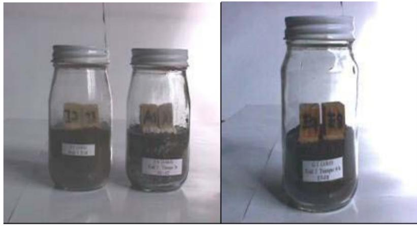
Figura 1. Prueba de soil/block. Frascos de vidrio conteniendo suelo, bloque de alimentación ya cubierto por el micelio del hongo y probetas, para la determinación de la pérdida de peso ocasionada por los hongos de pudrición blanca (*Trametes versicolor*), izquierda, y pudrición marrón (*Gloeophyllum trabeum*) derecha
