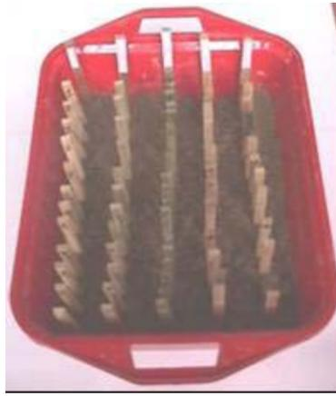
Figura 2. Envase plástico conteniendo suelo no estéril, microcosmos terrestre, empleado para evaluar la durabilidad natural e inducida de la madera de pino caribe frente a hongos de pudrición blanda.
