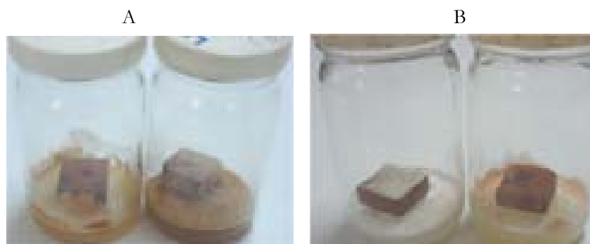
Fotos A y B. Prueba de durabilidad natural de las maderas estudiadas. A) probetas de Swartzia sericea ante la acción de los hongos de pudrición marrón, Gloeophyllum trabeum y Loeophyllum erubescens , en el 3 er mes del ensayo. B) probetas de Vochysia lehmanii ante la acción de los hongos de pudrición blanca, Trametes versicolor y Pycnoporus sanguineus en el 3 er mes del ensayo
