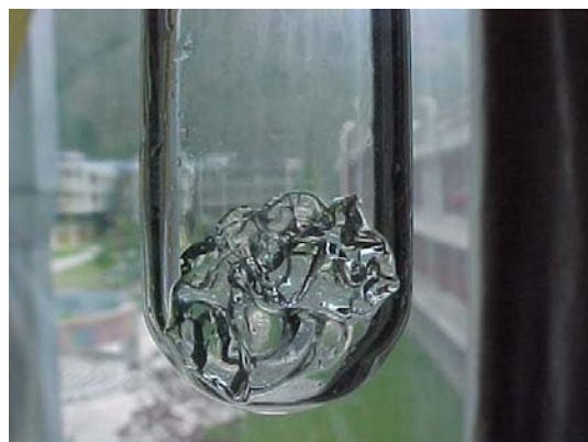
Fig. 4.-Fotografía del un hidrogel sintetizado mediante la polimerización a templado del ácido itacónico en presencia de quitosano.
