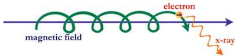
Figura 20. Radiación sincrotrón. Electrones moviéndose en un campo magnético irradian fotones
