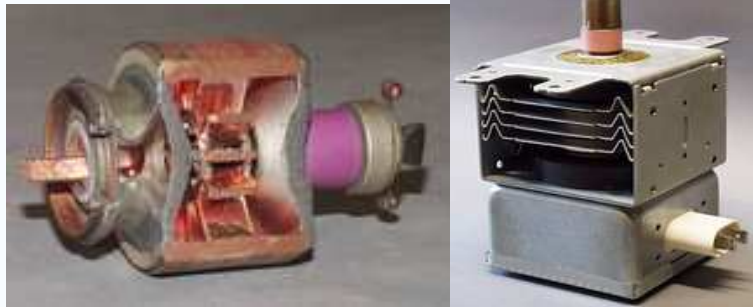
Figura 72. Magnetrones comerciales. A. Corte de magnetron
