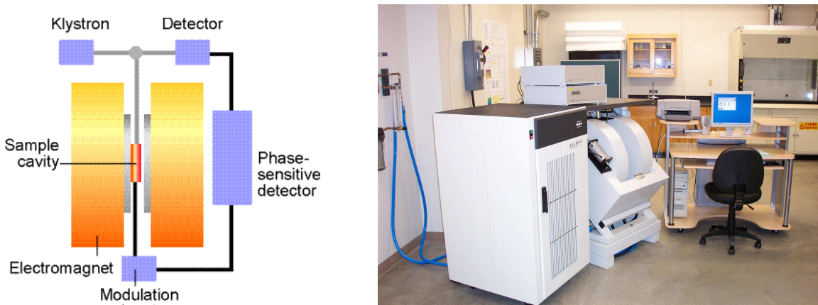
Figura 82. A. Esquema del instrumento ESR. B. ESR comercial.
