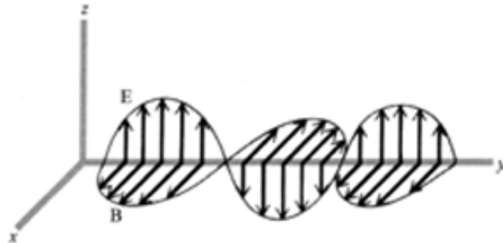
Figura 2. Onda electromagnética. Luz polarizada en el plano. E , campo eléctrico; B , campo magnético; y, dirección de propagación.
