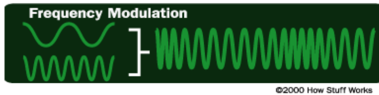
Figura 84. Modulación de la Amplitud (AM) y Modulación de la Frecuencia (FM)
