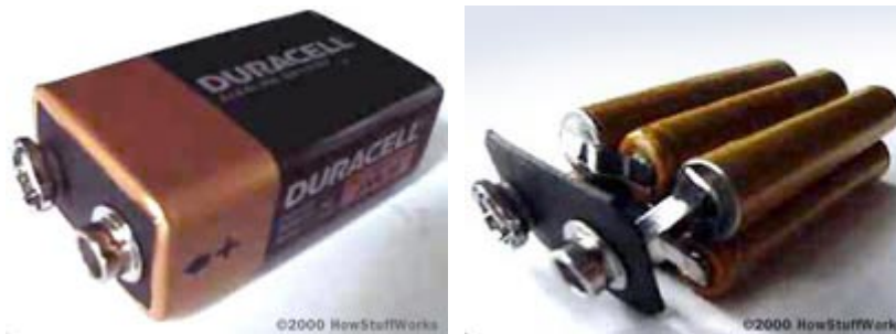
Figura 4.- Constitución de una batería comercial de 9 voltios
