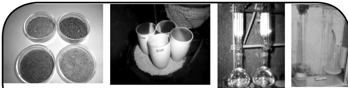
MUESTRAS DE ACR PARA DETERMINACIÓN DE HUMEDAD (DESECACIÓN EN ESTUFA), CENIZAS (INCINERACIÓN), GRASA (SOXHLET) Y PROTEÍNAS (KJELDAHL).
