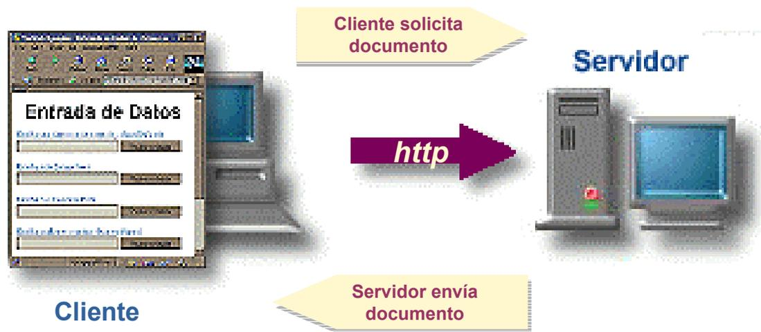
**Figura 1:** *Funcionamiento de un servidor Web*
